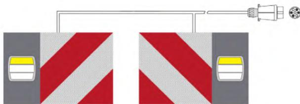
Homologierter reflektierender Warntafelsatz mit Beleuchtung nach EU 2015/208 oder TPESC-B, 282mm x 282mm, 1.0mm stark, Reflexfolie RA3,C, mikroprismatisch
