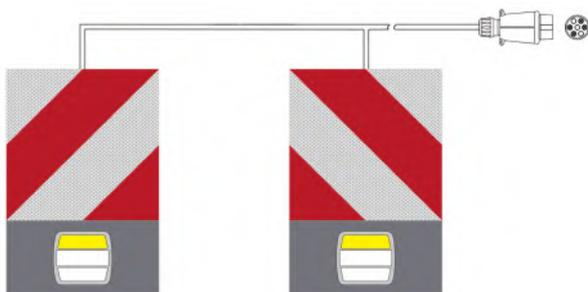
Homologierter reflektierender Warntafelsatz mit Beleuchtung nach EU 2015/208 oder TPESC-B, 282mm x 282mm, 1.0mm stark, Reflexfolie RA3,C, mikroprismatisch
