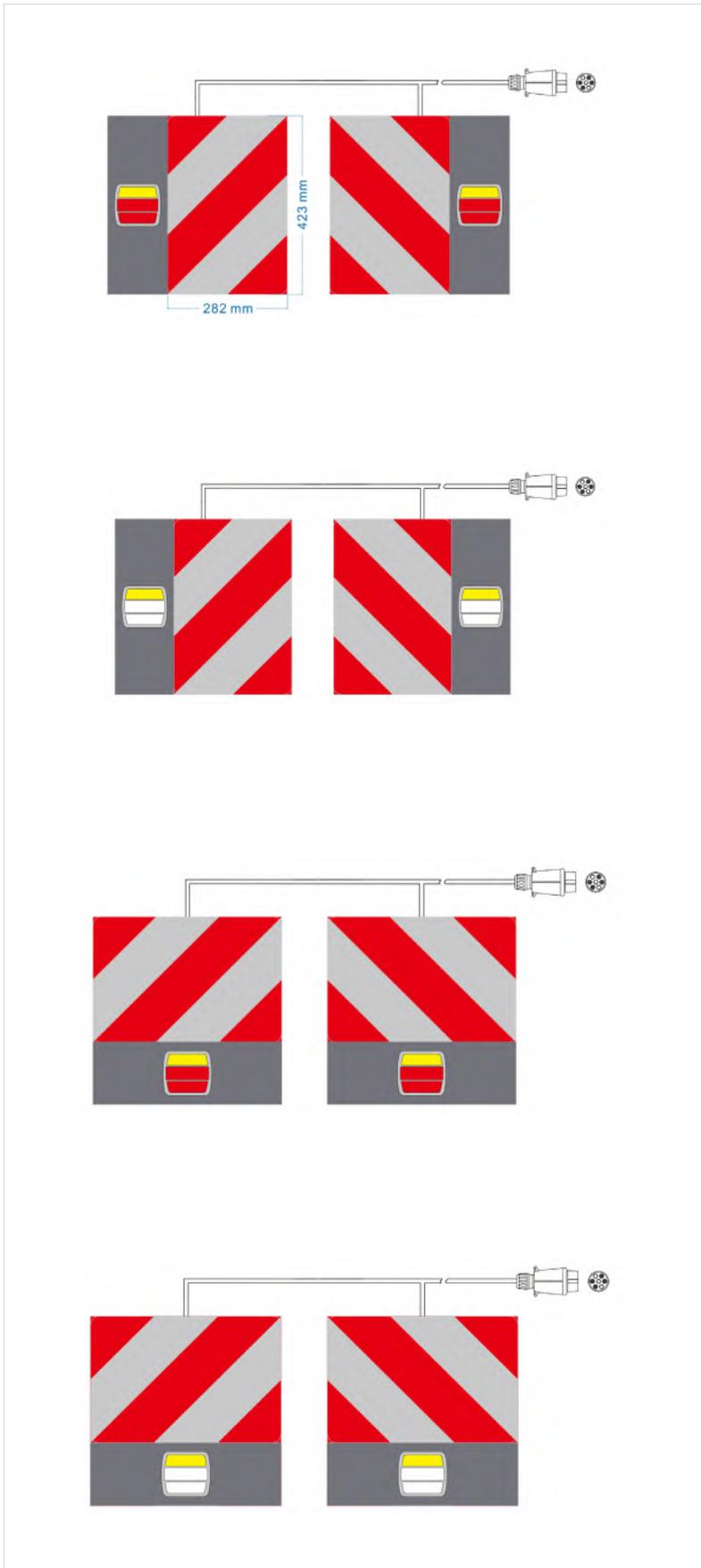
Homologierter reflektierender Warntafelsatz mit Beleuchtung nach DIN 11030 & TPESC-A, 423mm x 282mm, 1.0mm stark, Reflexfolie RA1, A
